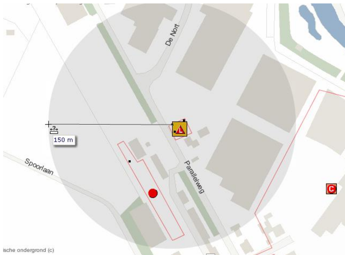
Afbeelding 4.4: Invloedsgedebied, 150 meter vanaf het vulpunt (Bron: Rapport Externe Veiligheid Spoorzone Woudenberg 24 januari 2014)
