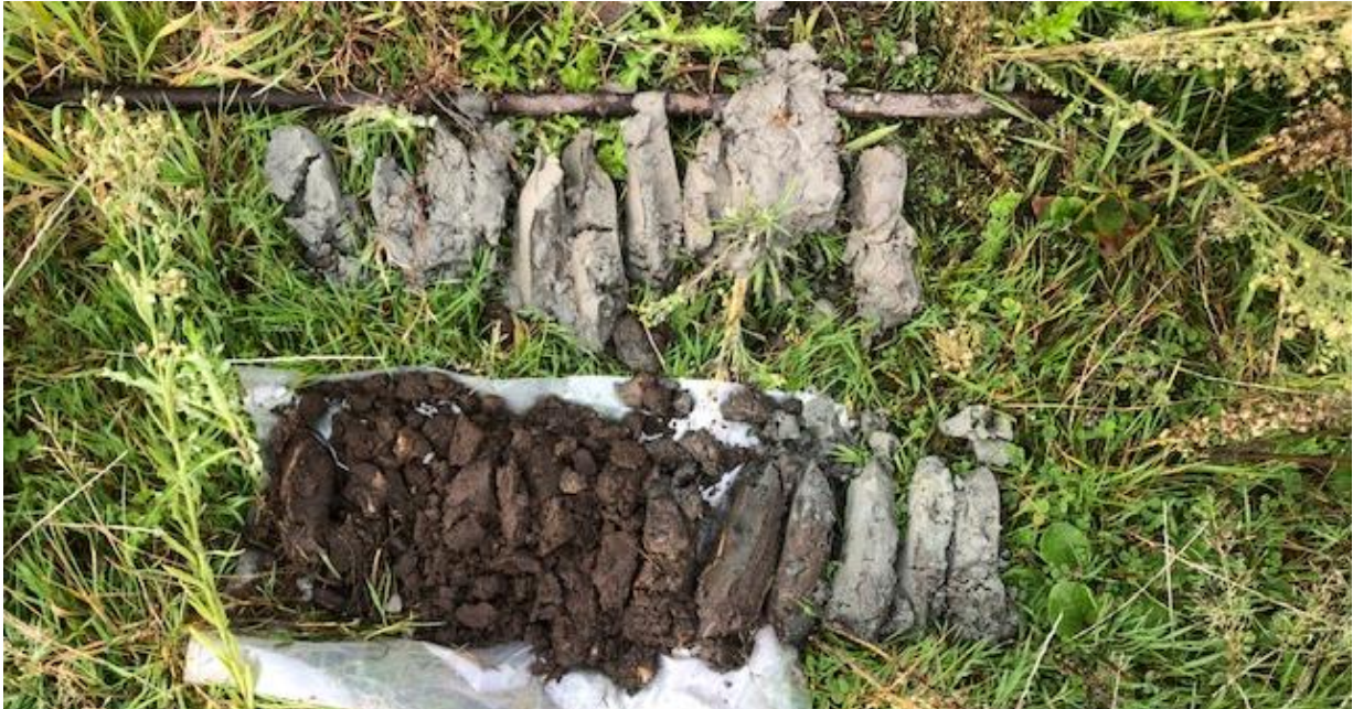
Boring 1 tot 230 cm -Mv (verdiept met guts tot 250 cm, niet afgebeeld: loopt uit)
